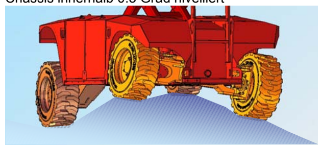
Arbeiten in voller Höhe durch autom. Achsausgleich Chassis innerhalb 0.3 Grad nivelliert
