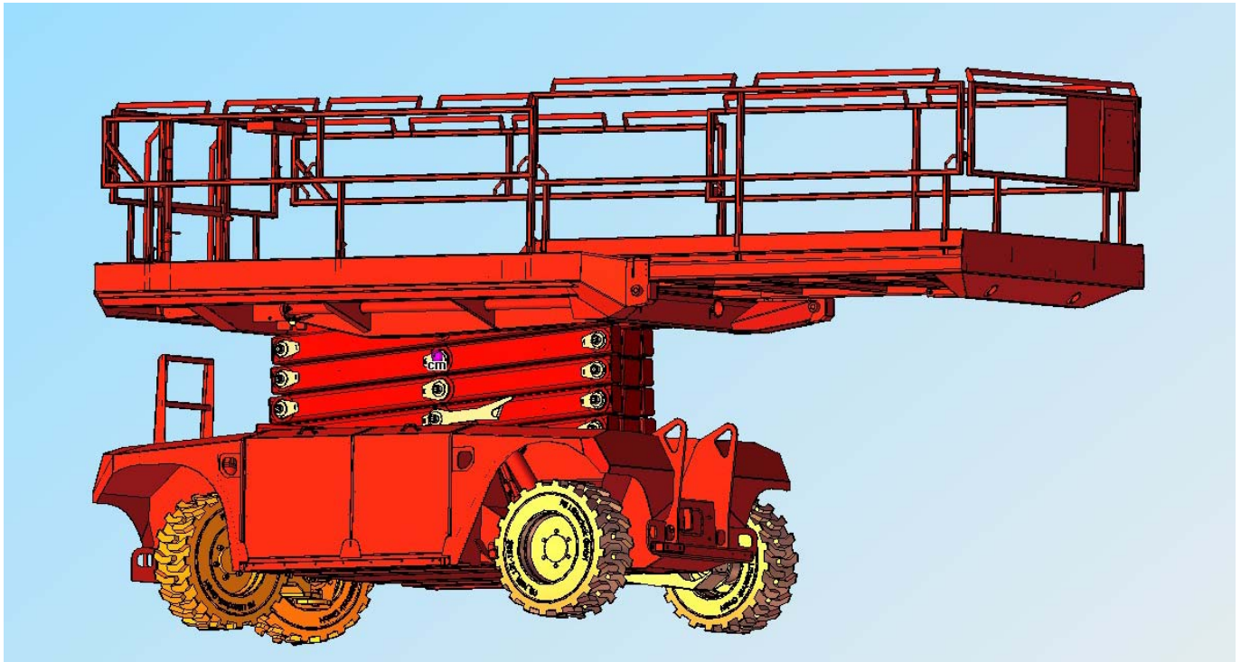
Mega-Deck: 11.8 qm Arbeitsfläche (6.25 x 1.90m), 500 kg Tragkraft / Standardplattform 650 kg Tragkraft
